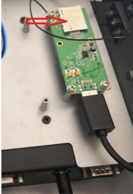
图 5.3 4G 上网模块安装 SIM 卡
