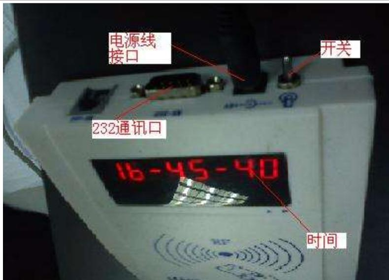
**电源线：**因刷卡器电源采用的是 5V 适配器，所以接线方法为从中间剪短，接入一根 4 芯信号线，其中两两拧在一起，4 芯线两端必须接法一致，否则电源接反，刷卡器将不能正常工作。
