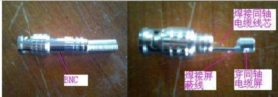
把 BNC 接头旋开，并把旋出后的尾部穿入同轴电缆，把同轴电缆剥出 1cm~1.5cm，并剥出线芯 3~5mm，注意屏蔽线不可剪断，并按上图指示焊接于 BNC 接头上，旋紧 BNC 接头盖。
