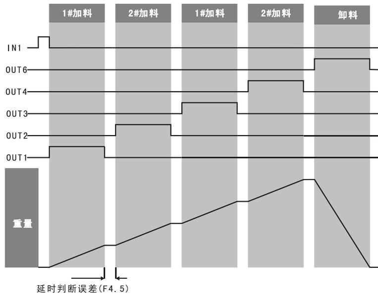
配料时显示器显示所喂物料的净重值，配料过程中可以按**启动/停止**按钮或INPUT1输入有效可以中止当前配料过程，重新按**启动/停止**按钮运行新的配料过程。
