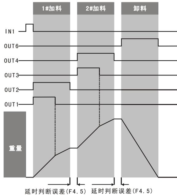
配料时显示器显示所喂物料的净重值配料过程中可以按启动/停止按钮或INPUT1输入有效可以中止当前配料过程，重新按启动/停止按钮运行新的配料过程。
